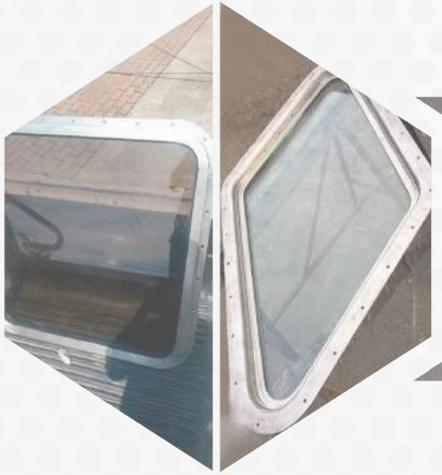
Las ventanas recibieron un acabado tipo sanitario y aplicación de sellador 3M de grado marino. Los cristales utilizados, eran templados y ahumados de 9mm de espesor con tratamiento de limpieza aplicación contra la corrosión.
